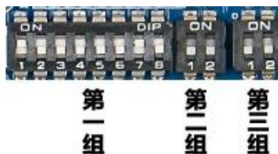
图 2-4 AD-S341-I1P2-MH 模块拨码开关
